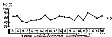
Рис. 3. Пространственная изменчивость среднеарифметической величины суммарной влажности десятиметрового слоя мерзлых глинистых грунтов на первой надпойменной террасе р. Пунги (протяженность участка 20 км).
