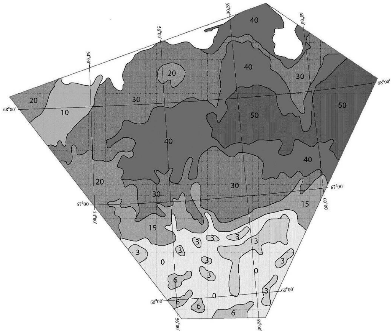
Рис.2.Схема районирования территории Болшеземельского артезианского бассейна по содержанию льда в мерзлых породах, где 0, 3, 6...50 – среднеинтегральное, в пределах выделенного контура, значение удельного (на единицу площади) содержания льда во всем разрезе мерзлой толщи, м 3 /м 2 или «эквивалентная» мощность слоя льда, м.
