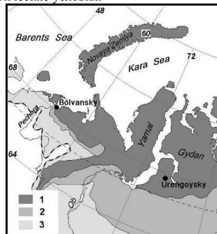
Рис.1. Расположение геокриологических стационаров Болванский и Уренгойский. Характер распространения ММП: 1 – сплошное; 2 – прерывистое; 3 – островное
