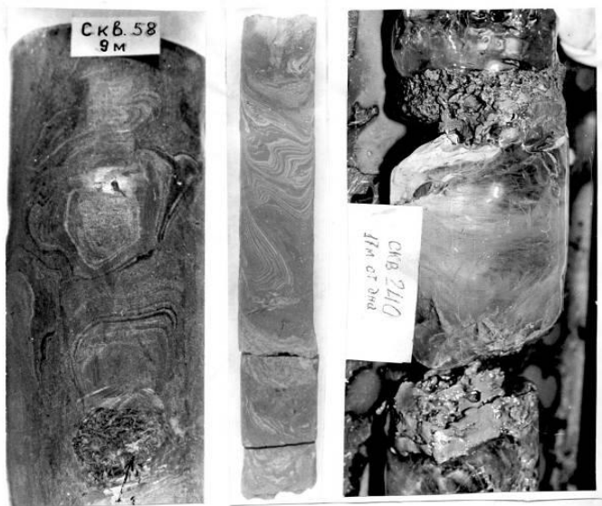
Рис. 3. Подземный лед в дислоцированных донных отложениях Баренцево-Карского шельфа [Мельников и Спесивцев 1995; Бондарев и др. 2001]
