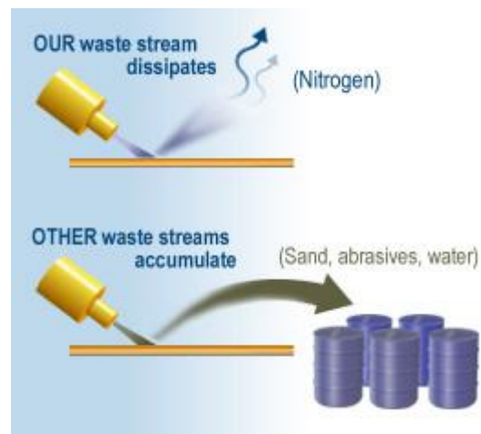
Рис 2. Удаление покрытий сверхзвуковой струей криоагента. Струя жидкого азота, выбрасываемая под высоким давлением, режет твердый материал как раскаленный нож – масло, а затем исчезает в воздухе
